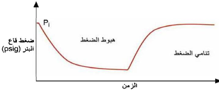
الشكل (10\_10): معاينة مقدار هبوط الضغط ومقدار تناميه.
