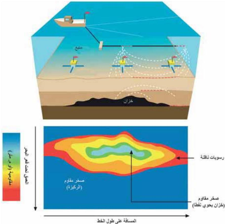
الشكل (3 - 10): مبدأ طريقة المسح الكهرومغناطيسي المتحكّم به لمسح قاع البحر.
