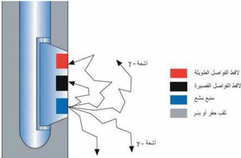
الشكل (6 - 49): قياس كثافة التشكل (Formation).
