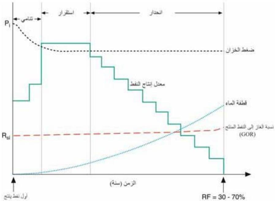
الشكل (9 - 8) : منحني سيماء إنتاج : دفع بواسطة الماء.
