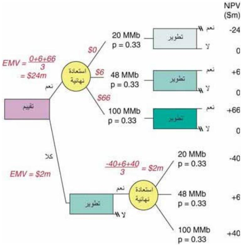
الشكل (8 - 5) : شجرة قرار معكوس (rolled-back).
