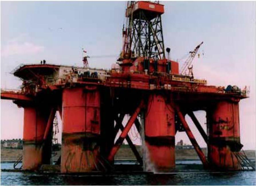
الشكل (4 - 3) : منصّات نصف - قابلة للغطس. (يأخذ من ستينا دريلينغ Stena Drilling)
