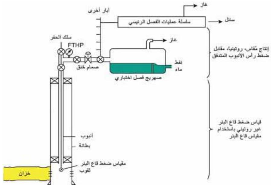
الشكل (10 - 9) : اختبار ضغط قاع البئر.
