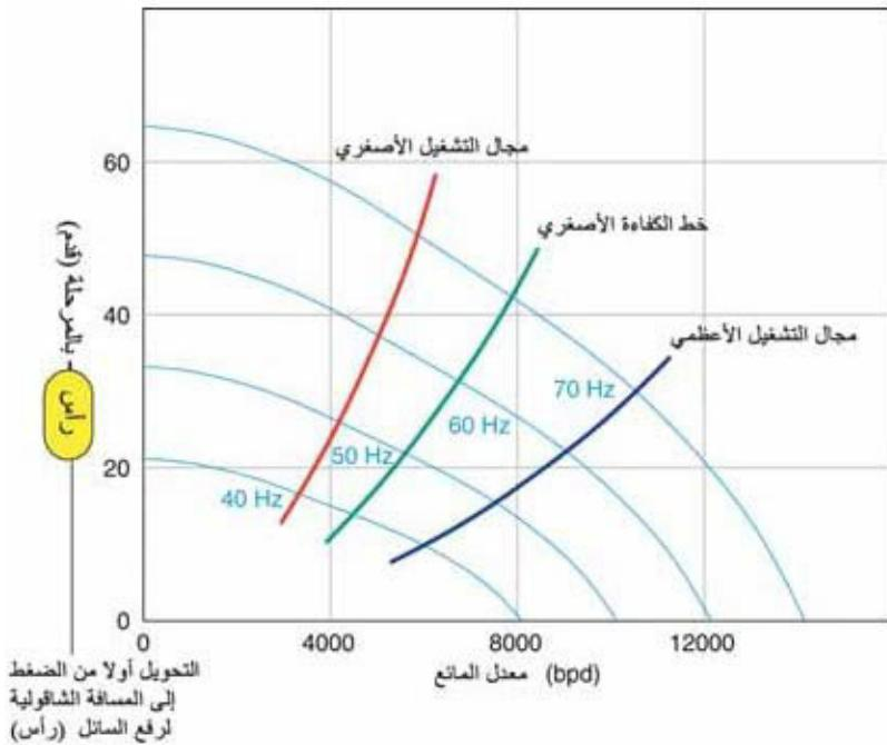
الشكل (10 - 28) : مرحلة المضخة الغاطسة الكهربائية.
