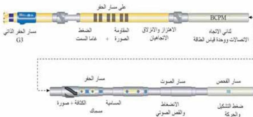
الشكل (6 - 38): أداة التسجيل البثري بتاكوميو (Pentacombo) صنع بيكو - هيوز.
