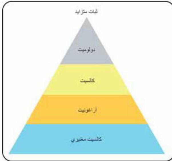
الشكل (6 - 11) : الثبات الكيميائي النسبي لفلزات الكربونات.
