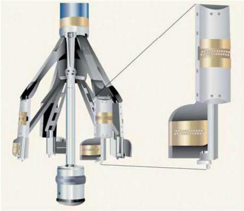
الشكل (6 - 58): أداة شلمبرجيه (FMI) تظهر أجزأ متمفصلة مع وسائل وأجنحة وأزرار.
